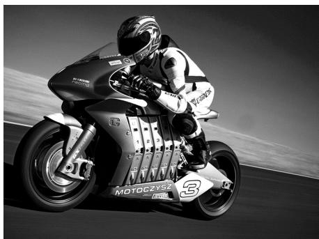
De meeste frames van motoren worden van staal gemaakt. Het frame van deze motor is gemaakt van carbonfiber. Dit zijn koolstofvezels die gecombineerd zijn met (kunststof)hars.
